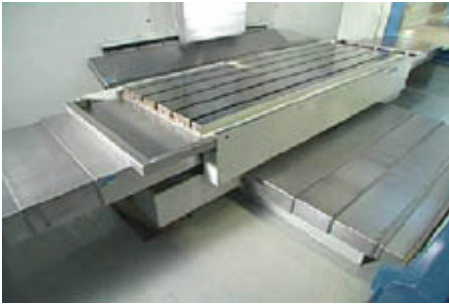
Şekil 3. Tezgahın rijitliği ve tablanın hareketleri
